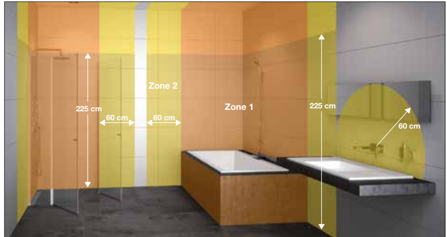
Voorbeeld: Indeling van de badkamer in veiligheidszones overeenkomstig de norm DIN VDE 0100-701
