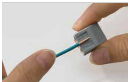
Striplengte Geleider 9 mm afstrippen
