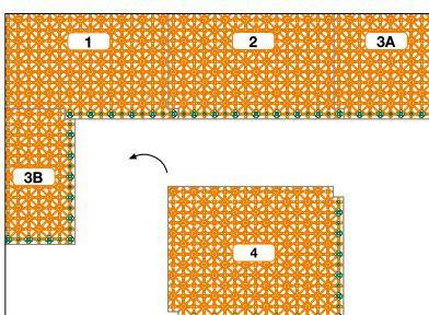
9 Die Verlegerichtung ist durch die, in der Darstellung grün gekennzeichneten verjüngten Verbindungsnotopen vorgegeben. Abschnitte ≥ 30 cm können am Beginn der nächsten Reihe eingepasst werden.
