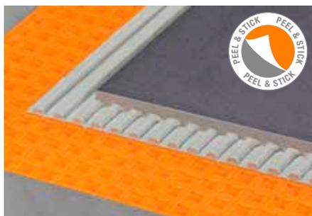
Schlüter-DITRA-PS est une natte en polypropylène avec des creux carrés contre-dépouillés au design Easyfill, et revêtue d'un non-tissé autocollant sur sa face inférieure. La natte est imperméable à l'eau et sert de désolidarisation et d'égalisation de la pression de vapeur. Après avoir retiré le film protecteur, vous pouvez poser DITRA-PS sur tout support adapté sans utiliser de mortier-colle. (Fiche produit 6.7)
