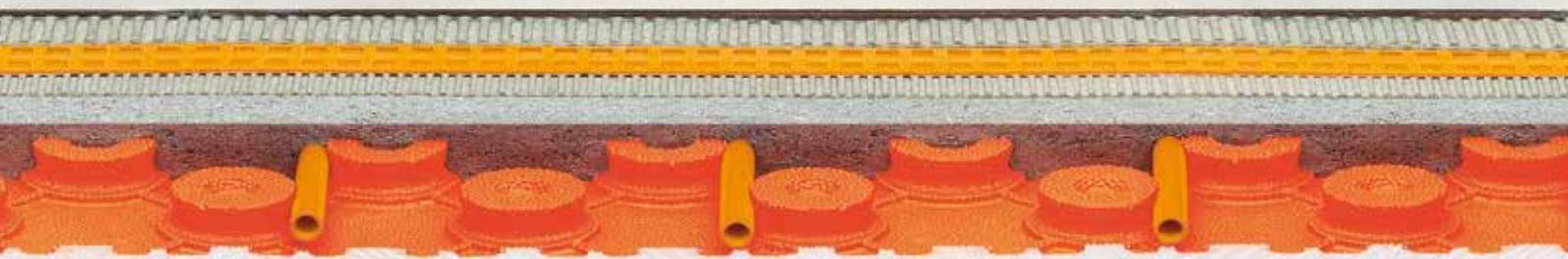
A partir de la structure de sol de faible épaisseur, Schlüter-BEKOTEC-THERM permet de réaliser – grâce à la technologie de chauffage, de rafraîchissement et de régulation – un chauffage par le sol économe en énergie, très réactif et efficace. Grâce à la faible hauteur et à la masse réduite de la chape, la température
