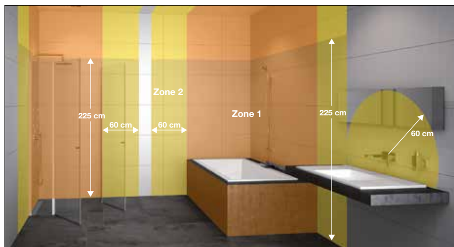
Exemple : répartition des zones de sécurité électrique de la salle de bains en référence à la norme allemande DIN VDE 0100-701
