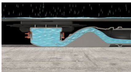
Effet auto-nettoyant grâce à la vitesse d'écoulement importante
