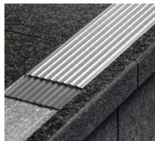
Schlüter-TREP-EFK est un profilé pour escalier en acier inoxydable, présentant un relief antidérapant spécial, permettant un agencement sûr et esthétique des nez de marche. Il peut se placer au moyen de mortier-colle dans des évidements prévus à cet effet, ou ultérieurement sur des marches.
