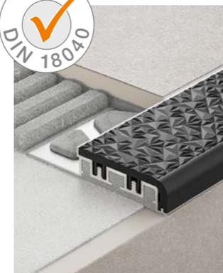
Schlüter-TREP-V est un profilé en aluminium pour escaliers, comportant une surface de marche interchangeable en matériau synthétique non-glissant. La vaste palette de couleurs des surfaces de marche permet d'assurer le contraste nécessaire avec le revêtement de sol adjacent. Le profilé est proposé au choix avec une surface de marche étroite (TREP-V 42) ou large (TREP-V 60).
