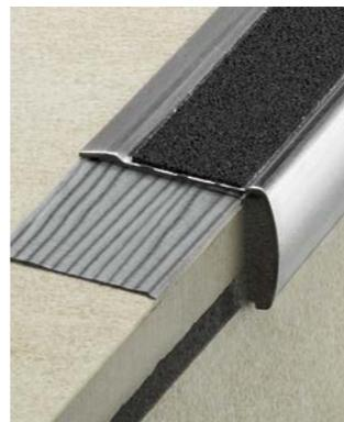
Schlüter-TREP-GK/-GLK est un profilé pour escaliers en acier inoxydable brossé avec une surface d'appui antidérapante collée. Il peut se coller ultérieurement sur des marches avec revêtement carrelé ou en pierre naturelle.
