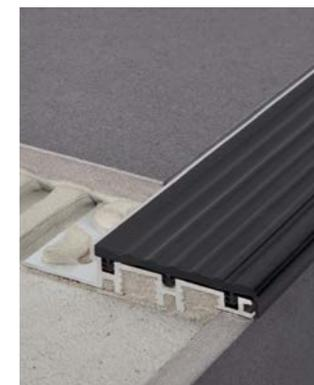
Schlüter-TREP-S/-B sont des profilés en aluminium ou en acier inoxydable, comportant une surface d'appui encastrée, interchangeable, en matériau synthétique antidérapant. Ils sont proposés au choix avec une surface d'appui large (TREP-B) ou étroite (TREP-S).
