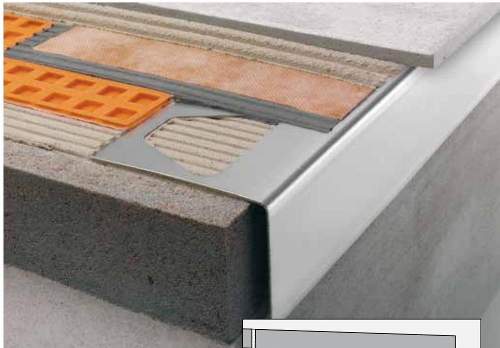
Schlüter®-BARA-E wird aus Edelstahl-Blechbändern, V2A (Werkstoff 1.4301) geformt. Edelstahl ist besonders für Anwendungen geeignet, die neben einer hohen mechanischen Belastbarkeit eine Beständigkeit gegenüber Chemikalienbeanspruchungen, z. B. durch saure oder alkalische Medien, Reinigungsmittel erfordern. Auch Edelstahl ist nicht gegen alle chemischen Angriffe beständig, wie z. B. Salz- und Flusssäure oder bestimmte Chlor- und Solekonzentrationen.
