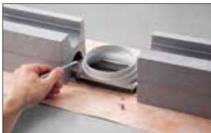
6 Adapter wieder auf Rinnenkörper stecken und fest verschrauben.
