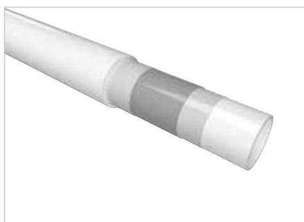
Schlüter-BEKOTEC-THERM-HR ist ein 5-Schicht-Verbund-Heizrohr aus hochwertigem Polymerwerkstoff (PE-RT) mit einer mittig liegenden Sauerstoffdiffusionssperre. Das sehr flexible Heizrohr gemäß DIN 16833 ist für die Verlegung in den BEKOTEC-Systemplatten optimiert. Die Sauerstoffdichtheit ist gemäß DIN 4726 zertifiziert und wird fortlaufend güteüberwacht.
