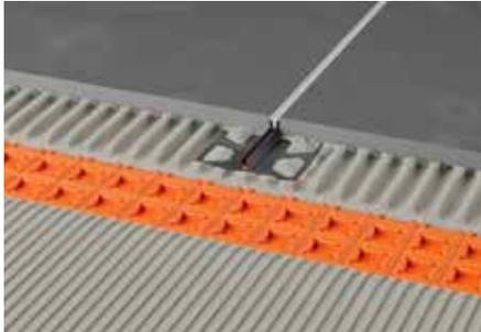
Schlüter-DILEX-FCS ist ein Bewegungsaufnahmeprofil mit Seitenteilen aus Hart-PVC-Regenerat und bildet eine ca. 3,5 mm schmale Bewegungsfuge ohne Kantenschutz und ohne zementäre Anbindung. Die integrierte Schutzabdeckung wird nach der Fliesenverlegung zur Aufnahme der Einlage Schlüter-DILEX-FIS entfernt. (Produktdatenblatt 4.23)
