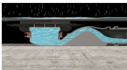
Selbstreinigungseffekt durch hohe Strömungsgeschwindigkeit
