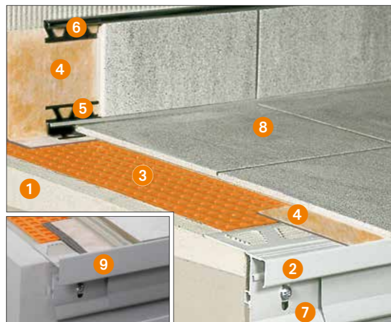
Aufbauvariante mit Balkonrandprofil 9 Schlüter-BARA-RTKEG
