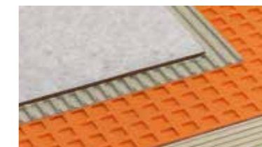
Schlüter®-DITRA 25 Izolační a separační rohož pro pokládání dlažby a obkladů na problematické podklady (např. dřevěné podlahy, sádrové nebo trhlinami poškozené podklady)
