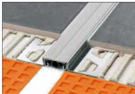
Schlüter-DILEX-KSBT est un couvre-joint de dilatation en aluminium ou en acier inoxydable V2A ou V4A, avec une zone de mouvement de 20 ou 30 mm en caoutchouc synthétique souple (voir fiche produit 4.19).
