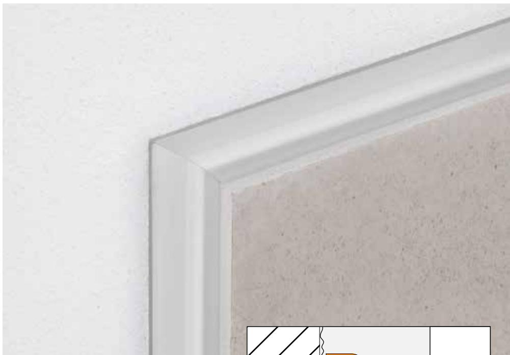
Le profilé doit être entièrement noyé dans la couche de contact avec le carreau afin d'éviter tout risque d'accumulation d'eau dans des cavités.
