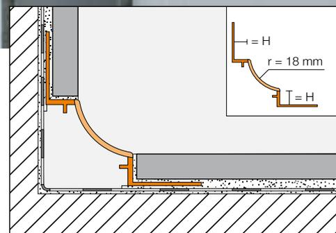
Le choix du profilé doit être déterminé au cas par cas, en fonction des contraintes chimiques, mécaniques et autres prévues.
