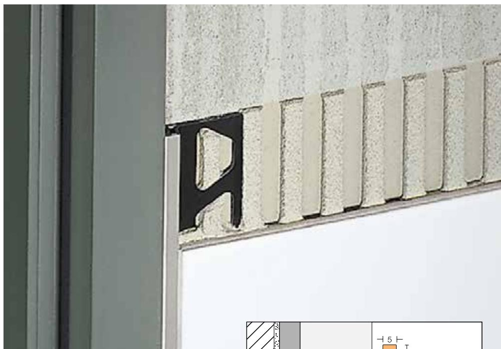
des contraintes chimiques, mécaniques et autres prévues. L'élément en CPE sur la partie supérieure du profilé résiste aux UV et est exempt de plastifiants.
