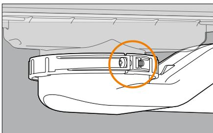
**3.** Zum Anschluss an die Entwässerungsleitung wird der Klemmring mittels beiliegendem Inbusschlüssel gelöst ...
