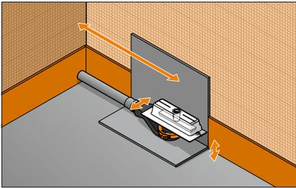
**5.** Nach Anschluss an die Entwässerungsleitung ist die gewünschte Positionierung nochmals zu prüfen. Zum Ausgleich von Unebenheiten und zum Höhenausgleich kann das Ablaufgehäuse auch auf einer Ausgleichsschicht passgenau ausgerichtet werden.
