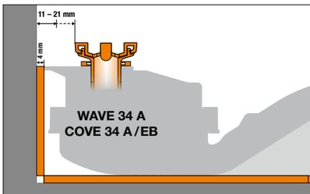
**2a.** Dadurch wird ein definierter Abstand zur aufgehenden Wand (ohne Wandbelag) bei Verwendung der WAVE-/COVE 34-Profile von 11 mm sichergestellt.
