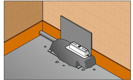
**7.** Der Gefälleestrich (2%) der Duschfläche wird so eingebaut, dass dieser das gesamte Ablaufgehäuse vollständig lastabtragend umschließt.
