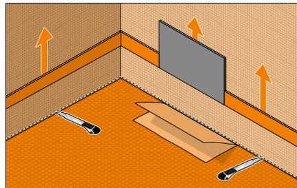
**9a.** ... Randdämmstreifen und Schallschutzelement höhengerecht abgeschnitten
