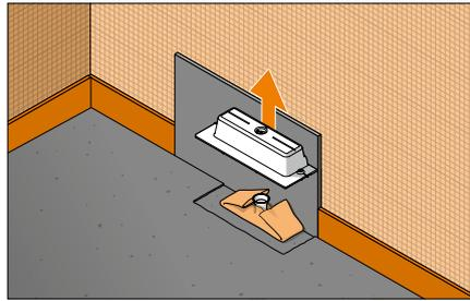
**8.** Nach Begehbarkeit der Estrichfläche wird der Bauschutzdeckel demontiert.
