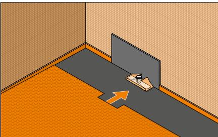
**9.** Im Anschluss wird DITRA mit Dünnbettmörtel (Zahnungsempfehlung 3 x 3 mm oder 4 x 4 mm) oder DITRA-HEAT (Zahnungsempfehlung 6 x 6 mm) fest auf der Estrichfläche verklebt und ...
