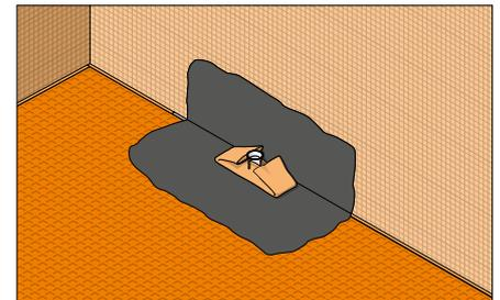
**10.** Zum Verkleben der KERDI Manschette wird auf der sich anschließenden Flächenabdichtung der Dichtkleber KERDI-COLL-L mit einer Zahnkelle 3 x 3 oder 4 x 4 mm aufgetragen ...
