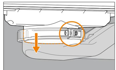
**4.** Anschließend ist zu prüfen, ob der Adapter noch bis zum Anschlag einsteckt. Danach ist der Klemmring wieder handfest anzuziehen.
