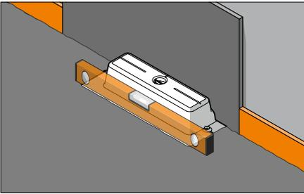
**7a.** Der werkseitig verschraubte Bauschutzdeckel dient hierbei als Ausricht- und Abziehhilfe und schließt bündig mit der Estrichoberkante ab.
