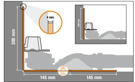
**2.** Beim direkten Wandeinbau wird das Ablaufgehäuse incl. Adapter und Bauschutzdeckel direkt mit dem im Set enthaltenen 4 mm dicken Schallschutzelement vor der aufgehen Wand positioniert.
