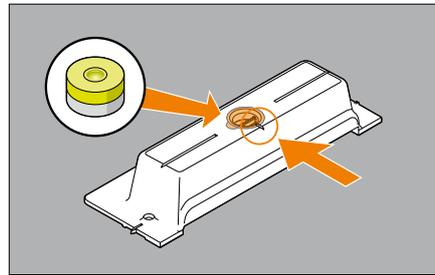
**1a.** Hierzu Mittelkennzeichnung auf dem Bauschutzdeckel beachten. Zur optimalen Ausrichtung kann die beiliegende Wasserwaagenlibelle in die dafür vorgesehene Vertiefung im Bauschutzdeckel eingelegt werden.
