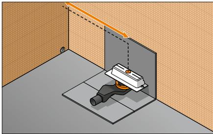
**1.** Das Ablaufgehäuse incl. Adapter mittig auf der Tragkonstruktion bzw. auf das mitgelieferte 4 mm dicke Schallschutzelement (ggf. auf geeigneter Trittschalldämmung) positionieren
