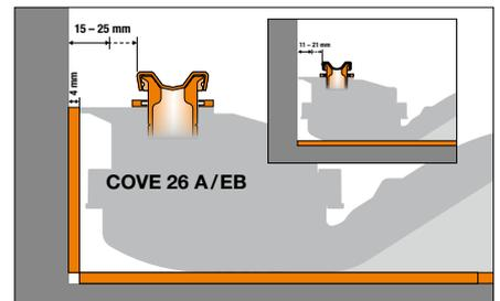
**2c.** Bei Verwendung von COVE 26-Profilen entsteht ein Wandabstand in Verbindung mit dem Schallschutzelement von 15 mm. Um hier ebenfalls einen Wandabstand von nur 11 mm zu erreichen, muss bei Verwendung der COVE-Profile auf die Anwendung des Schallschutzelementes im Wandbereich verzichtet bzw. die Differenz mit geeignetem Material, z.B. 5 mm Schlüter-KERDI-BOARD kompensiert werden.
