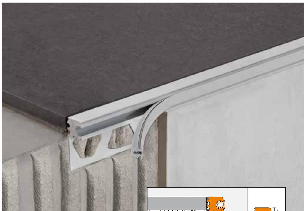
Alu. coloré : l'aluminium est prétraité (chromaté) et recouvert d'une laque polyuréthane en poudre appliquée par pulvérisation. Le revêtement est résistant aux UV et aux intempéries et sa couleur est stable. Les surfaces apparentes doivent être protégées de l'abrasion.
