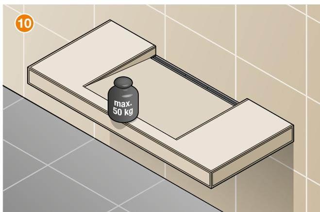
**Der Befestigungsuntergrund muss ebenflächig, lotrecht und für eine ausreichende Lastabtragung geeignet sein.**
