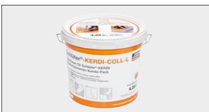
Schlüter®-KERDI-COLL-L ist ein zweikomponentiger Dichtkleber auf Basis einer lösemittelfreien Acrylatdispersion und eines zementären Reaktivpulvers. Er eignet sich zum Verkleben und Abdichten der Überlappungen und Stoßverbindungen von Schlüter-KERDI Bahnen
