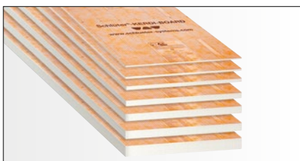
Schlüter®-KERDI-BOARD ist ein universell einsetzbarer Fliesen-Verlegeuntergrund für Wandbereiche aller Art, auch direkt als Verbundabdichtung. Schlüter-KERDI-BOARD ist auch als Untergrund für Spachtel- und Putzmörtel geeignet
