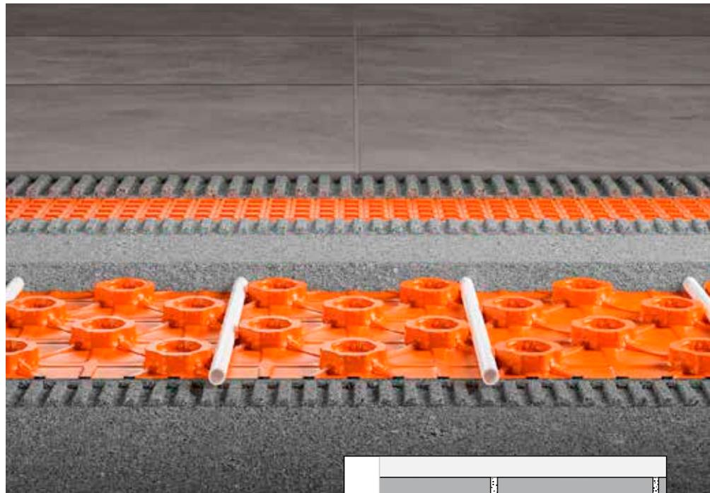
(alternativ: Schlüter-DITRA-DRAIN 4 oder Schlüter-DITRA-HEAT) verklebt (Calciumsulfatestrich  $\leq 2 \text{ CM-}\%$ ). Darauf erfolgt direkt im Dünnbettverfahren die Verlegung von Keramikfliesen oder Natursteinplatten. Bewegungsfugen in der Belagsschicht sind mit Schlüter-DILEX in den auch sonst geforderten Abständen herzustellen.
