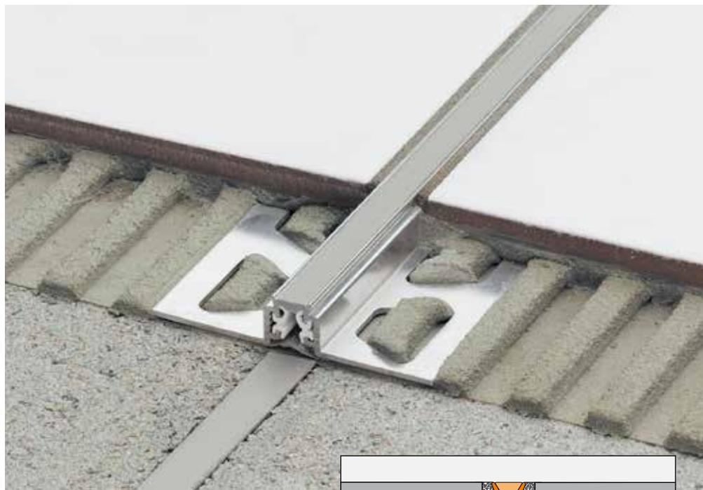
Die seitlichen Befestigungsprofile aus Aluminium sind empfindlich gegen alkalische Medien. Zementmaterialien in Verbindung mit Feuchtigkeit wirken alkalisch und können je nach Konzentration und Einwirkdauer zur Korrosion führen (Aluminiumhydroxydbildung). Das Profil ist vollsatt in die Kontaktschicht zur Fliese einzubetten.
